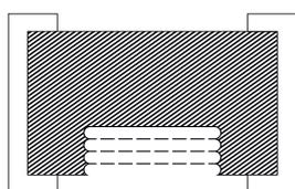
Dieser Schnitt kommt überwiegend bei hohen Spannungen oder großen Strömen am Widerstand zum Einsatz, da der Stromlinienverlauf besonders optimal liegt.
