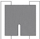
Es ist ein gerade Schnitt parallel zu den Lötanschlüssen des Widerstandes. Der Trimmschnitt sollte in der Mitte liegen und vor der aktiven Kohleschicht beginnen.
