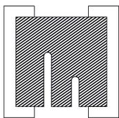
Es sind zwei gerade Schnitte parallel zu den Lötanschlüssen des Widerstandes. Der Trimmschnitt soll bei  $\frac{1}{3}$  und  $\frac{2}{3}$  der Widerstandslänge liegen.
