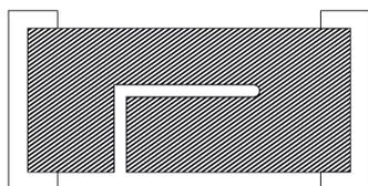
Der Name kommt von der Form des Laserschnittes. Ähnlich dem Double-Plunge-Schnitt soll hier mit einem Cut off von 10% bis 15% gearbeitet werden, um danach in den zweiten Schnitt längs des Widerstandes zu kippen.
