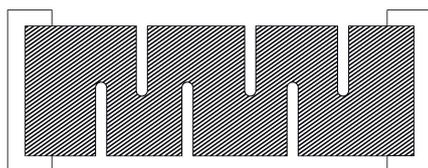
Bei diesem Schnitt wird der Widerstand in einer mäandrierförmigen Form getrimmt. Der Schnitt erlaubt eine hohe Widerstandsänderung, allerdings auf Kosten der Langzeitstabilität und des Stromrauschens.
