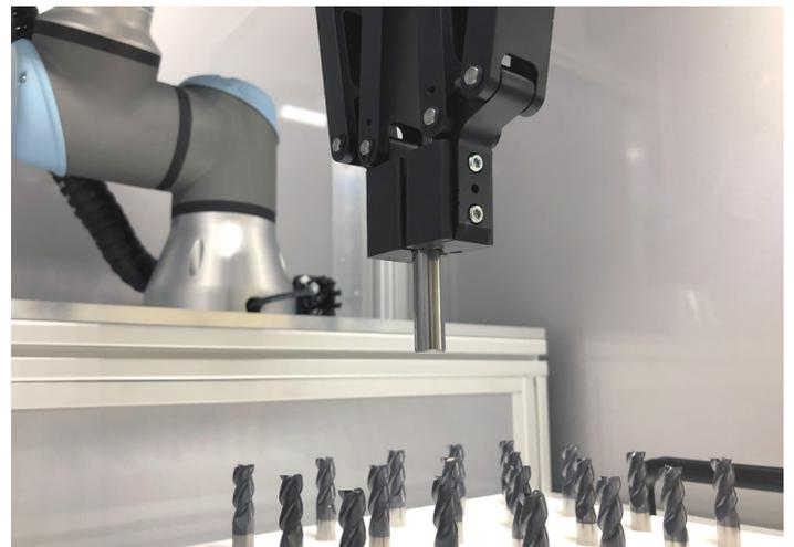
Un robot industriel intégré dans la **Workstation** retire les objets d'un porte-pièces puis les remet en place. Six articulations permettent un déplacement libre à chaque endroit à l'intérieur de la station laser. Cela permet de réduire les étapes de travail pour l'utilisateur et donc les temps de cycle. Les robots offrent un grand potentiel d'économie grâce à une meilleure qualité de produit, en particulier lors de la manipulation de composants sensibles.
