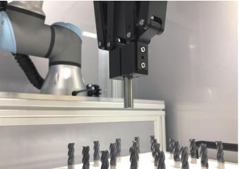
Ein in die Workstation Robotic integrierter Industrieroboter entnimmt Objekte aus einem Werkstückträger und
